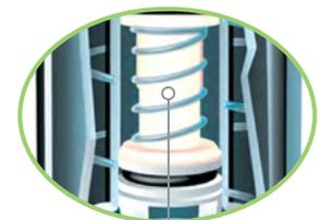
Le régulateur de pression breveté incorporé compense les pressions élevées ou variables de l'eau afin de garantir une performance optimale
