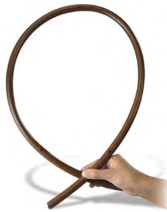
Avec sa flexibilité améliorée, le goutteur en ligne XFD est facile à installer et résiste au tortillement. Le goutteur en ligne peut être courbé jusqu'à un rayon de 7,62 cm sans se pincer
