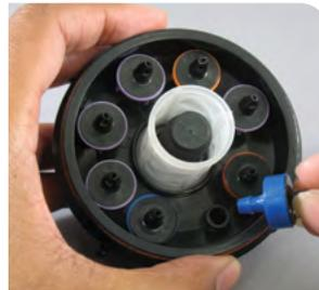
Astuce utile : installez toujours les goutteurs avec l'extrémité pointue (entrée cannelée) ou fileté vers le haut, comme illustré
